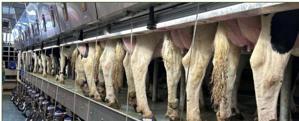
La bovina entra nella posta di mungitura, è riconosciuta tramite il trasponder (su collare, pedometro o marca auricolare) e i dati sono registrati e consultabili in tempo reale sul display
