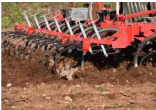
Figura 18 – La distribuzione con solchi chiusi prevede organi che coprono il solco utilizzato per l'iniezione del liquame.
