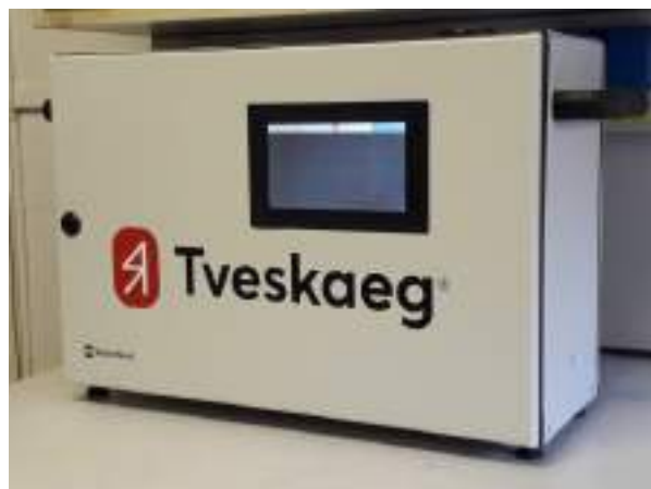
Figura 6 – Strumento per la valutazione indiretta del contenuto in nutrienti basato sulla risonanza magnetica nucleare (NMR).
