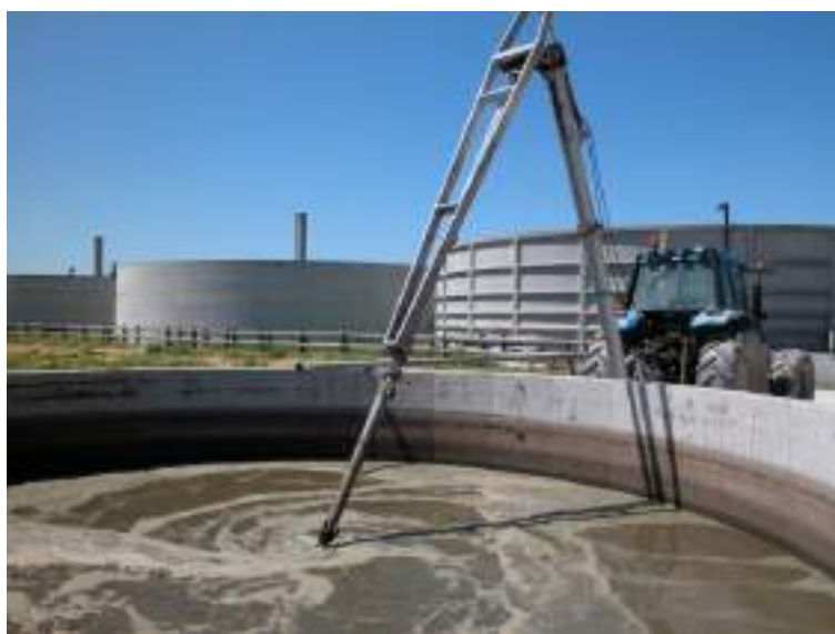
Figura 8 – Miscelazione di una vasca di liquame con attrezzatura mossa dalla presa di potenza della trattoria.
