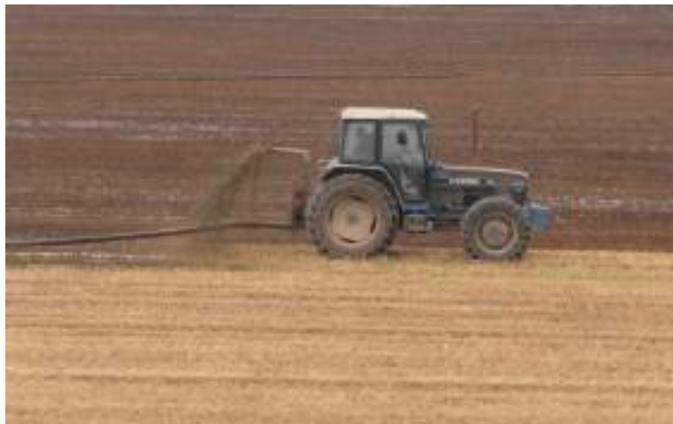
Figura 12 - Distribuzione degli effluenti con piatto deviatore rivolto verso il basso a bassa pressione.
