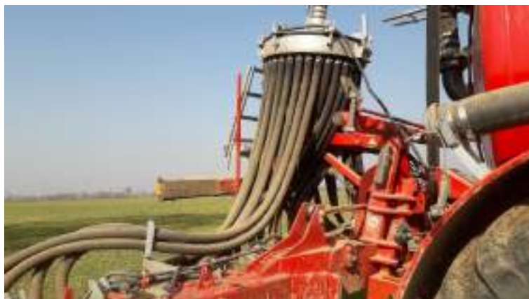
Figura 21 – Il ripartitore assicura l'uniformità di distribuzione trasversale
