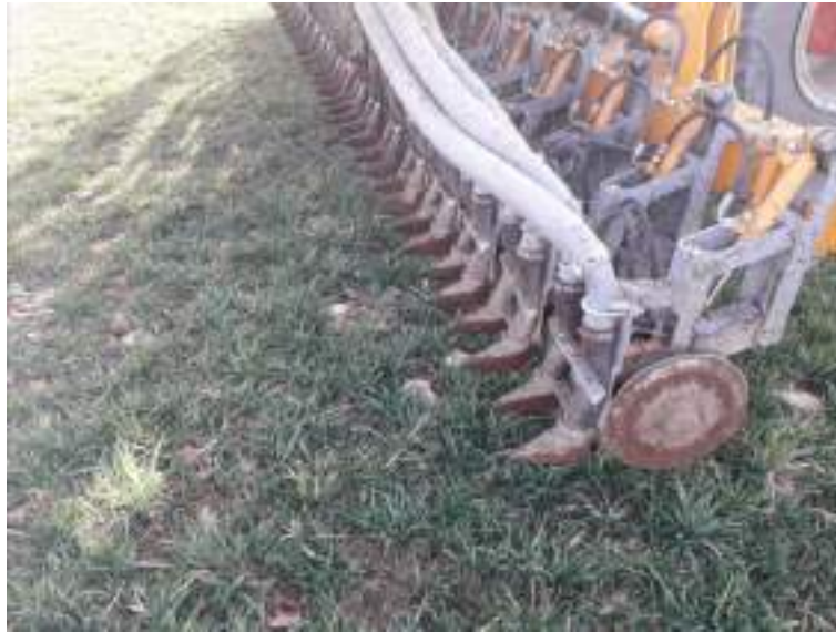
Figura 15 – La distribuzione su prati e in copertura di cereali autunno vernini può essere effettuata con organi dotati di scarpette metalliche che strisciano sul terreno e dischi scarificatori.
