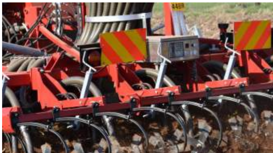
Figura 5– Attrezzatura per la distribuzione dei liquami con regolazione della dose in relazione alla velocità di avanzamento e il contenuto di azoto misurato tramite NIR.
