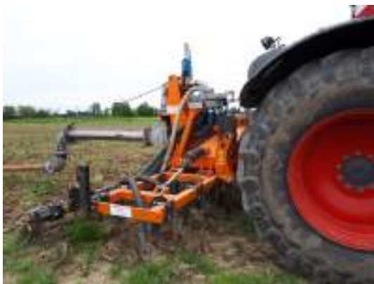
Figura 16 – Attrezzo per la distribuzione sotto-superficiale del liquame. L'incisione effettuata dai denti dell'erpice e di alcuni centimetri e il solco non viene chiuso.
