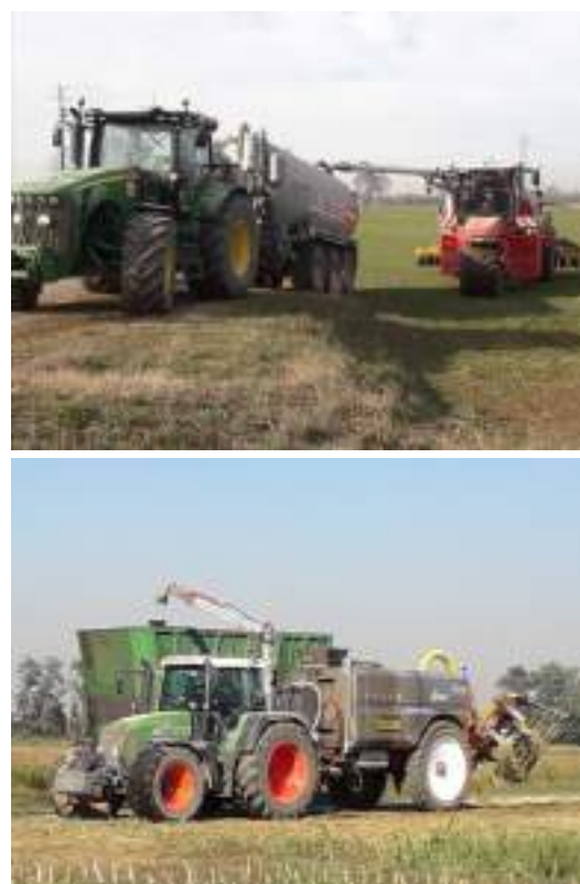
Figura 24 – Il rifornimento delle attrezzature di distribuzione a bordo campo consente di mantenere elevata la capacità di lavoro anche quando la distanza tra vasca e campo è elevata.
