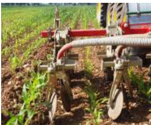
Figura 20 – La tecnica di distribuzione con solchi aperti può essere utilizzata anche per distribuire liquame nell'interfila del mais. Si notino i dischi per la chiusura del solco.
