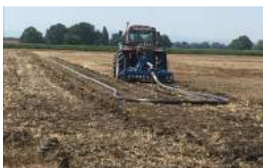
Figura 23 – Il sistema ombelicale consente di utilizzare la sola trattrice con un attrezzo portato per la distribuzione dei liquami evitando il compattamento del terreno.
