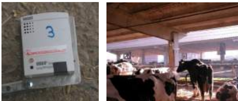
Figura 49 – Datalogger per temperatura, umidità, intensità luminosa e sua installazione.
