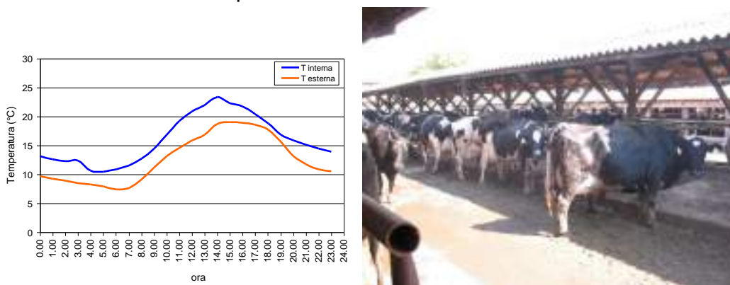
Figura 11 - Andamento della temperatura interna ed esterna (a sinistra) registrata in una struttura bassa con copertura non coibentata (a destra).
