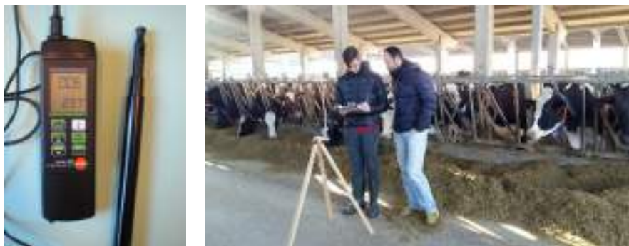
Figura 50 – Anemometro a filo caldo per la misura della velocità dell'aria nelle stalle
