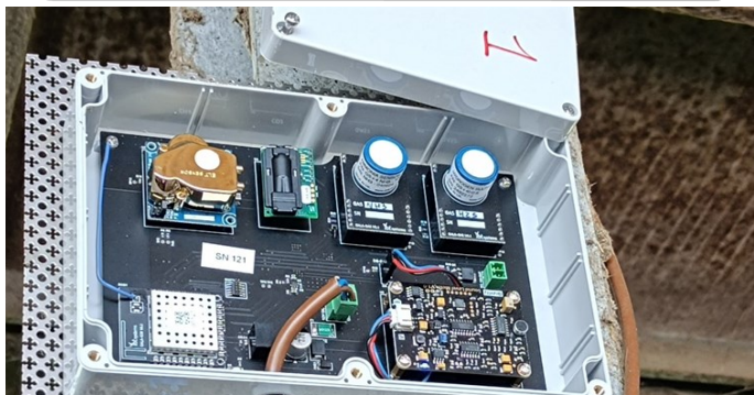
Centralina per il monitoraggio della qualità dell'ambiente (concentrazioni di gas, rumore)
