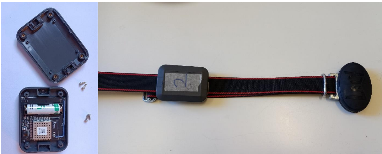
Figura 7 - Contenitore con il dispositivo accelerometrico sviluppato dal progetto. A sinistra contenitore aperto, a destra installato sul collare.
