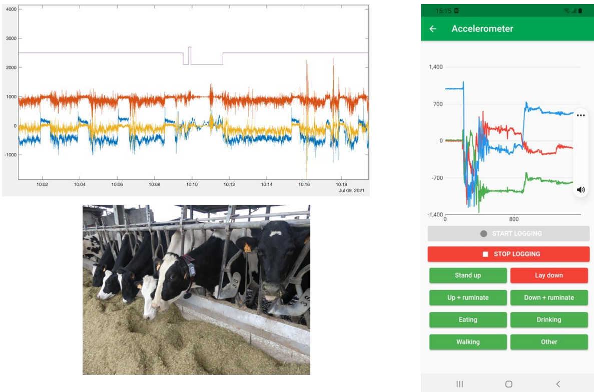
Figura 2 – Esempio di tracciato dell'accelerazione sui tre assi (in alto a sinistra) ottenuto tramite la registrazione dei dati tramite telefono e apposita app (a destra) con la quale è possibile indicare il comportamento della bovina monitorata (a sinistra in basso).
