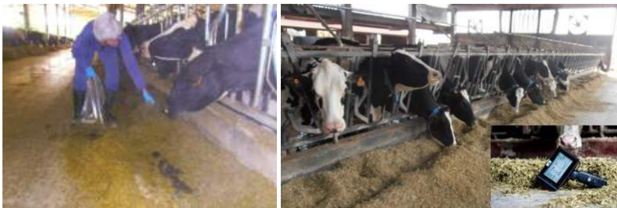
Figura 32 – Raccolta di campioni di alimento e NIR portatile per le analisi
