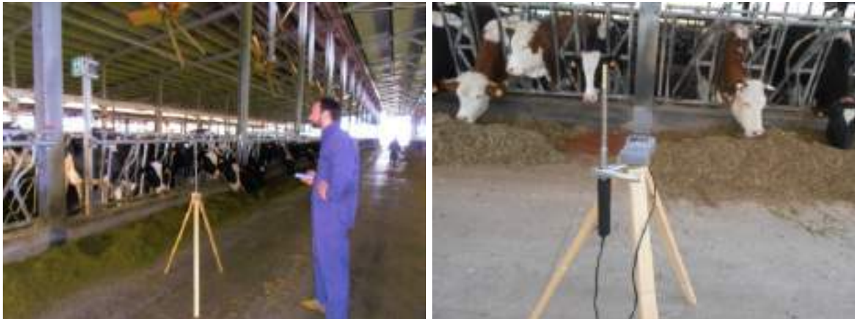
Figura 25 – Utilizzo dell'anemometro a filo caldo in stalla
