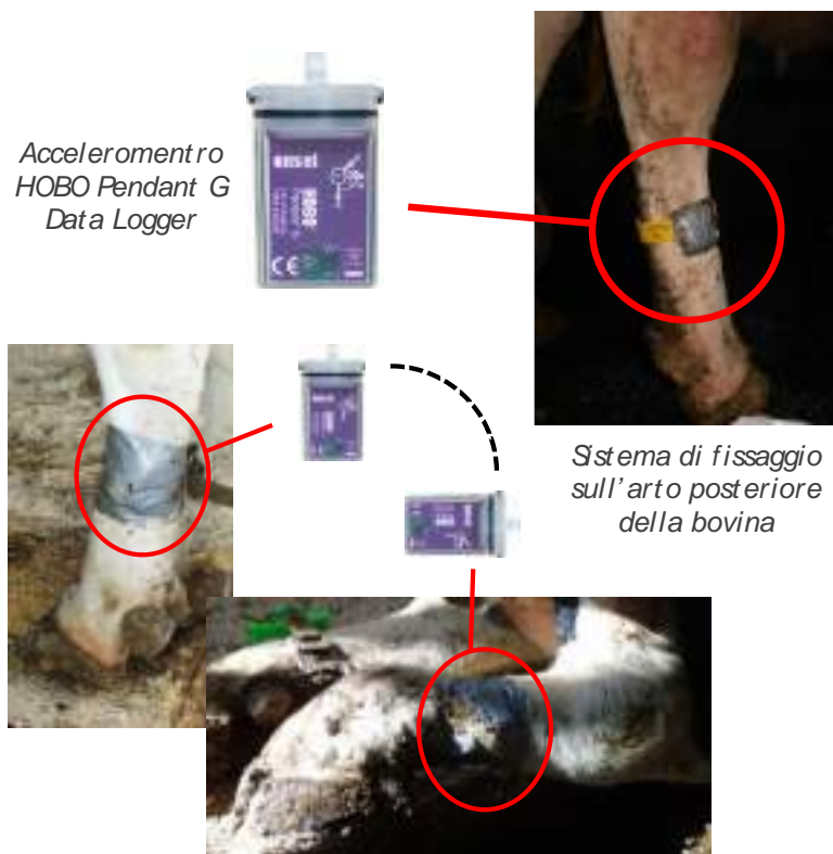
Figura 21 – Accelerometri utilizzati e loro collocazione sulle bovine
