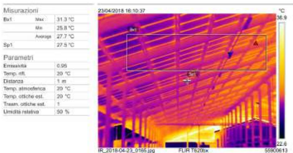
Figura 28 – Esempio di elaborazione dell'immagine termica per determinare la temperatura delle superfici
