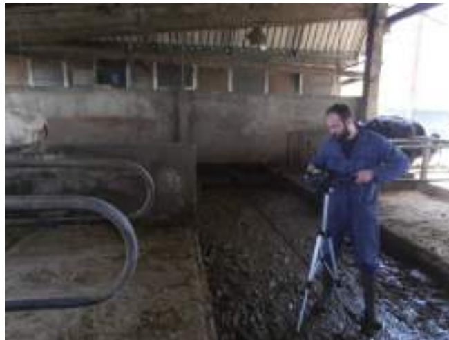
Figura 27 – Utilizzo della termocamera in stalla per il rilevamento della temperatura del fondo della cuccetta
