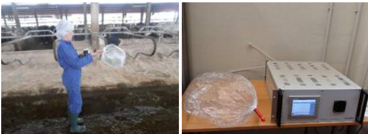
Figura 24 – Raccolta di un campione di aria in stalla (a sinistra) e sua analisi in laboratorio (a destra)
