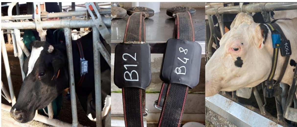
Figura 5: I sensori N2 montati sulle vacche. A sinistra: una vacca che indossa un sensore con la protezione originale che consisteva in diversi strati di nastro adesivo e un'etichetta bianca per identificare il numero del sensore. Al centro: protezione successiva, realizzata in gomma termorestringente per adattarsi perfettamente alla scatola del sensore. I numeri erano scritti sulla gomma con un pennarello bianco. A destra: una vacca che indossa un sensore con protezione in gomma, oltre a un sensore commerciale (Allflex® HTPro, C-sense™, SCR Engineers Ltd., Netanya, Israele).
