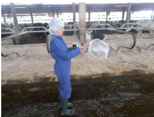
Il campionamento dell'aria nella zona di stabulazione e la successiva analisi consente di valutare la concentrazione di gas nell'aria
