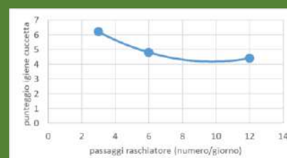
Miglioramento del punteggio di igiene della cuccetta in relazione alla frequenza di funzionamento dei raschiatori.
